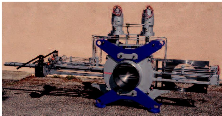
ONIS PL2V 18" 300#, приводится в действие дистанционно, с помощью гидравлического привода - FFCU, линия перекачки
